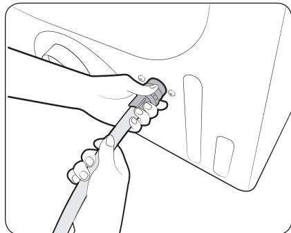
1. Branchez la partie coudée du tuyau d'eau au robinet de remplissage situé en bas du panneau arrière. Tournez le raccord à la main jusqu'à ce qu'il soit serré.
