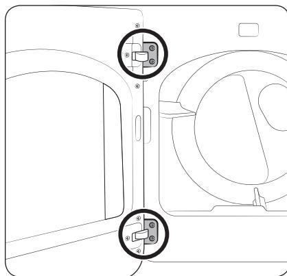
12. Réinstallez le hublot sur le cadre avant, puis insérez et serrez soigneusement les 4 vis de charnières.
