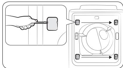
6. Utilisez un tournevis à tête plate pour retirer les deux caches de charnières sur le côté d'origine. Installez les caches de charnières sur le côté opposé, comme indiqué.
