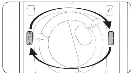
4. Retirez les deux vis du dispositif de fermeture, puis enlevez le cache du dispositif.
