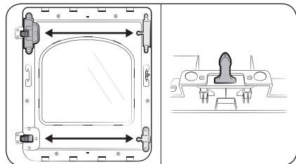
8. Retirez le dispositif de fixation du verre et inversez les positions :
