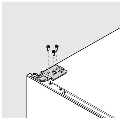
Si el transporte de la unidad requiere la remoción de la puerta, debe tener un espacio de puerta de 9 mm uniforme alrededor del perímetro del compartimento para garantizar el sellado correcto de la junta y evitar la escarcha en el congelador. Mida la separación de 9 mm entre el metal del compartimento y el metal de la puerta.
