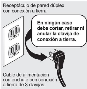
Use una toma de corriente dúplex con conexión a tierra para cada unidad (es decir, dos receptáculos de toma de corriente dúplex, cada uno en un circuito eléctrico dedicado) para una configuración de unidades acopladas.
