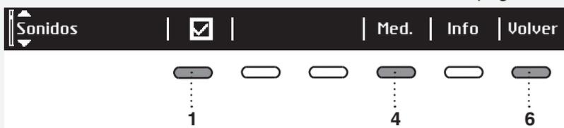
Con la tecla 1 seleccionar el encendido  o el apagado  de la señal acústica.
