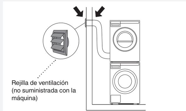
⚠ Este aparato no debe salir a una chimenea, una pared, un techo, un ático, un espacio de rastreo o el espacio oculto de un edificio. Sólo un conducto de metal rígido o flexible se utilizará como escape. Sólo podrá utilizarse una rejilla de ventilación de metal. Si el conducto es llevado a una toma de corriente, será colocada una rejilla de ventilación para evitar el flujo inverso de aire frío. Ajuste la rejilla de ventilación hacia el exterior de la pared.
