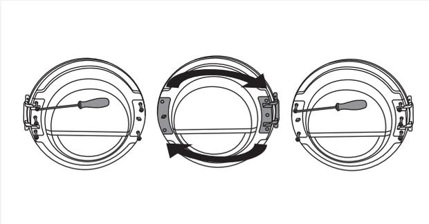
**6** Desatornillar el segmento de la bisagra de la puerta (izquierda) y el segmento del enganche de la puerta (derecha), reemplazarlos y volver a atornillar (el segmento de la bisagra de la puerta en el lado derecho y el segmento del enganche de la puerta en el lado izquierdo).
