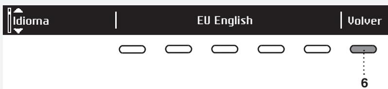
Con la tecla 6 vuelve a "Configuración del sistema" (System settings).
