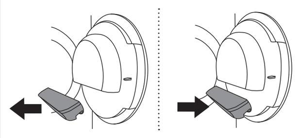
En el caso de que haya extraído accidentalmente **toda** la caja del filtro de red en la puerta, volver a instalarlo en la misma posición.
