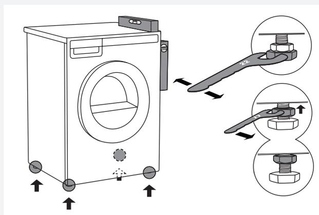
Coloque la secadora en una posición estable. Nivelar la secadora de forma horizontal y vertical girando las patas ajustables con una llave N° 22 (0.87") (máx. 15 mm (0.59")). Luego ajuste las tuercas con la llave n° 17 (0.67") hacia la parte inferior de la máquina ↑.
