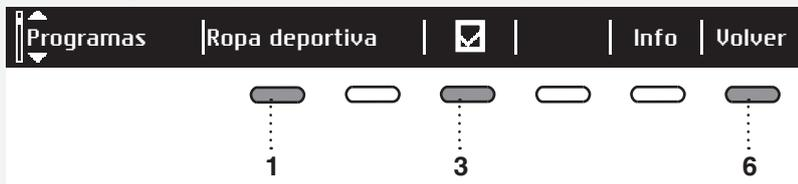
Presione la tecla 1, para que aparezca . Con el selector o la tecla 1 seleccionar el programa. Lo visualizado se determina con la tecla 3: encendido  /apagado .
