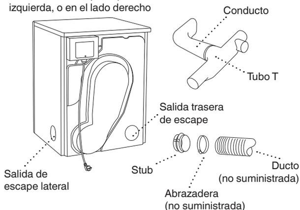
El conducto no debe ser montado con tornillos u otros sujetadores que se extiendan en el conducto y atrapen pelusa.
