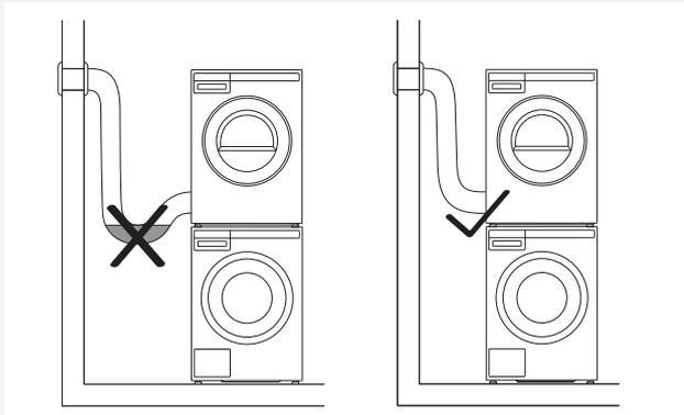
💡 Al instalar en climas cálidos (77 °F y superior) con altos niveles de humedad, no ponga el conducto de escape de aire hacia arriba.
