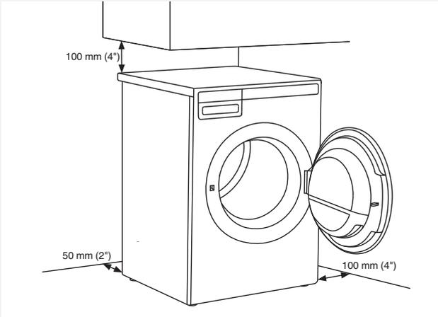
💡 La secadora no puede estar en contacto con una pared o muebles adyacentes. Para un funcionamiento óptimo de la secadora, observe el espacio libre de la pared como se muestra en la figura.
