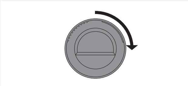
**8** Girar 90° el obturador de vidrio de la puerta para que la marca que indica la apertura de la puerta esté en el otro lado.
