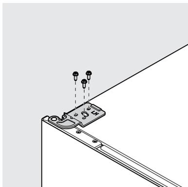
Si le transport de votre unité nécessite le retrait de la porte, vous devez avoir un écart de porte uniforme de 9 mm autour du périmètre de l'armoire pour assurer un joint d'étanchéité adéquat afin d'éviter le gel dans le congélateur. Mesurez l'espace de 9 mm entre le métal de l'armoire et le métal de la porte.
