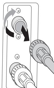
**4** Enchufe el cable de alimentación en un tomacorriente correctamente conectado a tierra.
