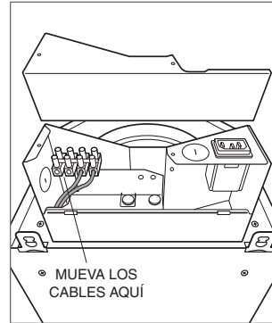
Ubicación del cableado
